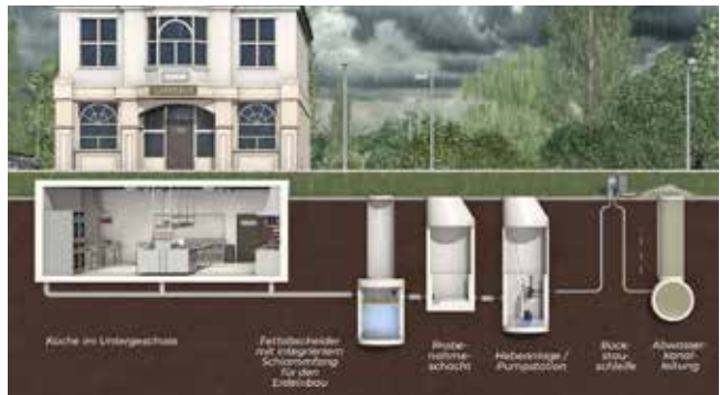
Beispiel für eine Fettabscheideranlage mit Rückstausicherung (GET / Grafik: Mall)
