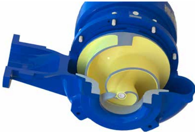
Foto: Zu sehen bei KSB auf der IFAT 2022: Die jüngste Generation der „D-max“-Laufräder vereint hohe Betriebssicherheit bei Transport von Rohabwasser mit bestmöglicher hydraulischer Effizienz. (KSB SE & Co. KGaA)
