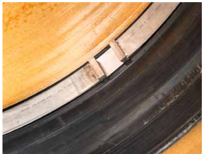
Das Prüfverfahren nach DIN 19523 bestätigt, dass die Innendichtmanschette RedEx den zu erwartenden Belastungen durch die Hochdruckreinigung standhält.
