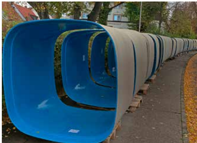
Amiblu NC Line – mit seinen ausgereiften Neubau- und Sanierungslösungen stellt Amiblu dem Markt seit Jahrzehnten einen nachhaltigen und bewährten Qualitätsstandard für nicht-kreisrunde Rohrleitungen zur Verfügung. Foto: Amiblu Germany GmbH
