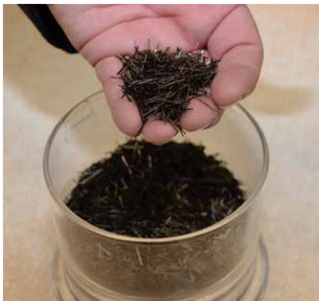
Basaltgestein wird zu Fasern verarbeitet und verstärkt den Rinnenwerkstoff Beton.
