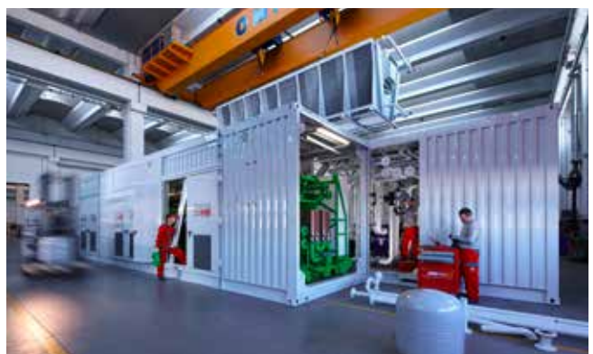
AB Energy fertigt maßgebliche Systemkomponenten wie schlüsselfertige und modulare KWK-Anlagen. Quelle: AB Energy
