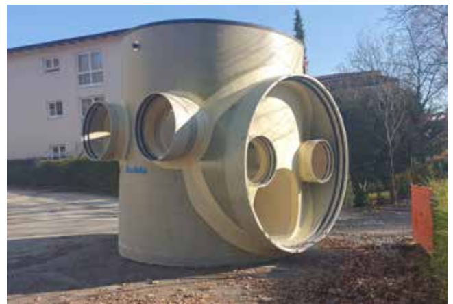
An beiden Enden des Stauraumkanals ist jeweils ein GFK-Schacht angeordnet. Zu sehen ist hier der oberliegende Schacht mit den beiden Anschlüssen für den Beckenüberlauf (links) zur Ableitung in den Kocher und den beiden Anschlüssen für das Amiscreen-System (rechts).
