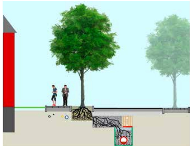
Abbildung 5: Nutzung des Leitungsgrabens für die Speicherung von Niederschlagswasser und der kontinuierlichen Bewässerung des Wurzelraums von Großbäumen.
