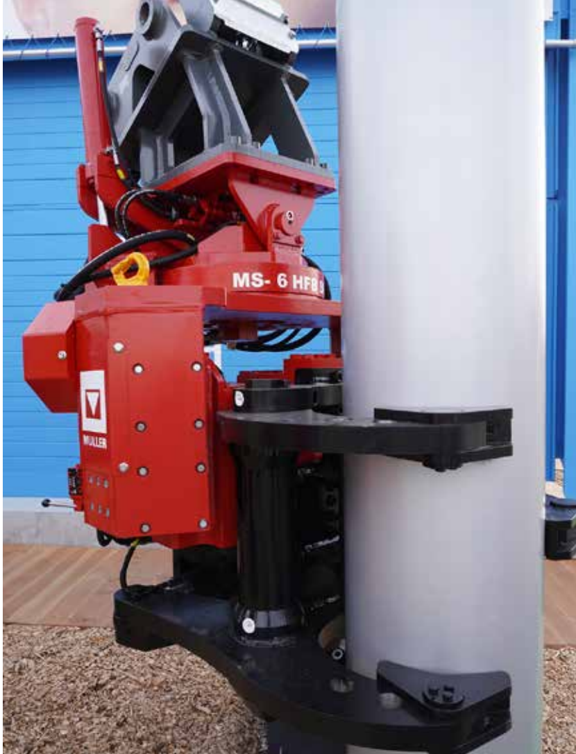
Die Baggeranbauvibrationsrammen der HFB-Serie wurden einem Facelifting unterzogen. Foto: terra infrastructure GmbH
